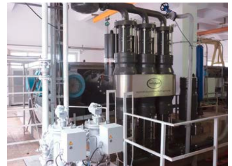
Mit der MULTISAFE Doppel-Schlauchmembranpumpe wird selbst kritischer Ascheschlamm zuverlässig über große Entfernungen gepumpt. By means of the MULTISAFE double hose-diaphragm pump even critical ash slurry is reliably pumped over long distance.
